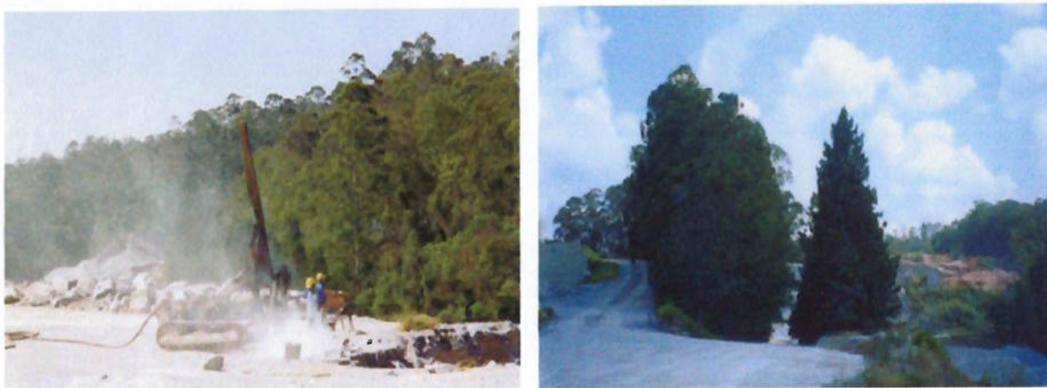
Figura 12 -Situação crítica de produção de poeira na perfuração e barreira de cinturão verde atuante.
