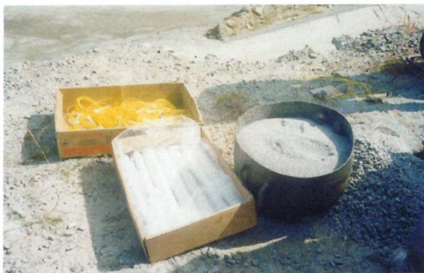
Figura 17 -Sistema de iniciação não elétrico, emulsão encartuchada e NAOC
