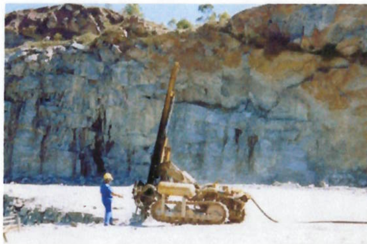
Figura 28 - Perfuratriz Pneumática com dispositivo de contenção de poeira
