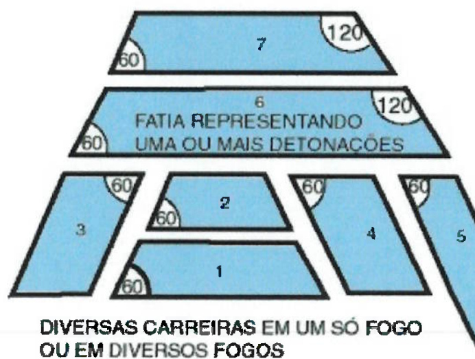
Figura 58 – Esquema de sequência de detonações para diversos fogos
