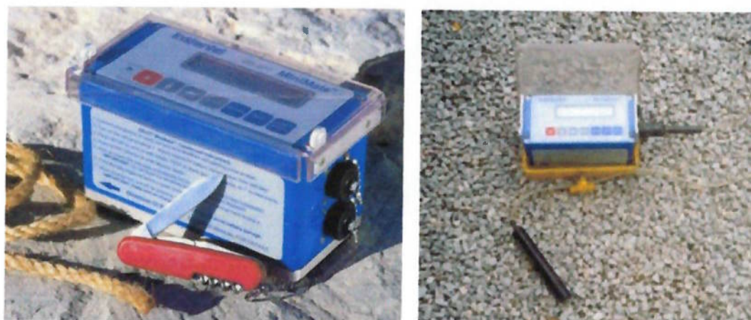
Figura 35 - Sismógrafos preparados em campo
