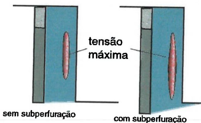
Figura 49 – Tensões devido a subperfuração
